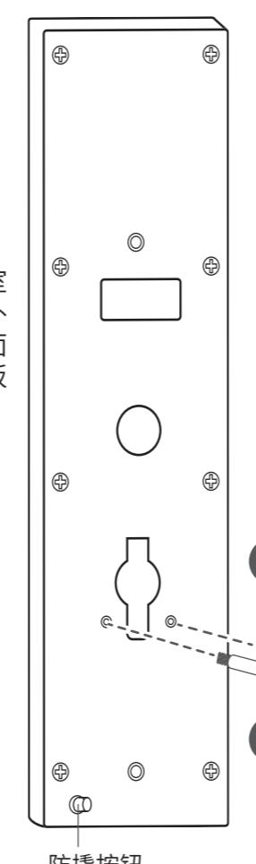
7 安装完成后, 重新上电, 锁体自动识别开锁方向。如果锁体开锁方向异常, 请长按室内面板“重置”键5秒将门锁恢复出厂设置, 重新识别开锁方向。
